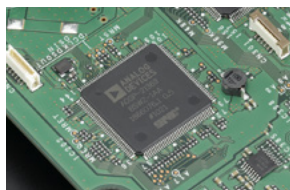
Per la IF principale DSP, unità di trasmissione ADSP-21363 clock @333 MHz
