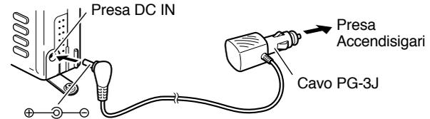
**ATTENZIONE:** PER COLLEGARE UN ALIMENTATORE ESTERNO A 24 V PER MEZZO DI UN CONVERTITORE c.c. - c.c., UTILIZZARE SOLO IL CAVO PER ACCENDISIGARI PG-3J. IN QUESTO CASO, L'USO DEL CAVO PG-2W POTREBBE ESSERE CAUSA DI INCENDIO.
