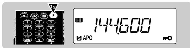
Stando nel modo Blocco del Ricetrasmittitore si potrebbe voler usare il comando **Sintonizzazione**. Accedere il Menu No. 9 (ENC) per attivare o disattivare (settaggio di base) la funzione Attivazione Comando Sintonizzazione.
