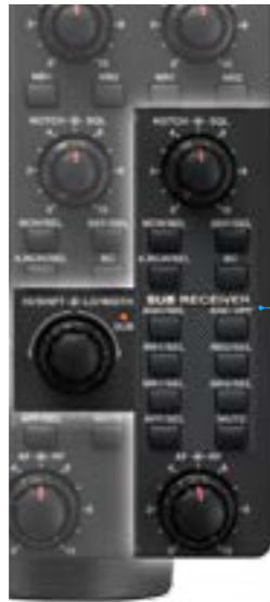
Sub-Ricevitore con controllo eliminazione interferenze estesa centrata nella parte destra del pannello principale
