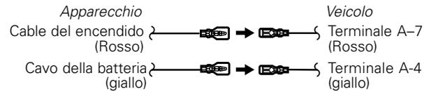
[2] Il terminale A-7 (rosso) del connettore ISO del veicolo è collegato alla fonte di alimentazione costante, e il terminale A-4 (giallo) è in connessione con la chiave di accensione del veicolo.
