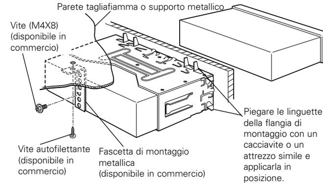
⚠ Accertarsi che l'apparecchio sia installato saldamente in posizione. Se l'apparecchio è instabile, possono verificarsi problemi di funzionamento (per esempio, possono verificarsi interruzioni di suono).
