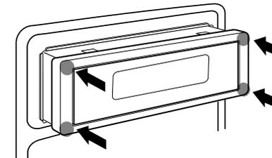
⚠ Per montare l'unità, assicuratevi che la parte frontale del pannello di controllo sia rivolta verso di voi e incastratela nella manica di montaggio premendo i quattro lati della cornice di gomma allo stesso tempo. Non applicare una forte pressione alle altre sezioni della cornice, altrimenti si potrebbero avere problemi, come ad esempio la difficoltà di aprire e chiudere il pannello.
