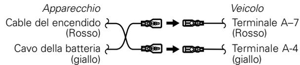
[3] Il terminale A-4 (giallo) del connettore ISO del veicolo non è collegato a nulla, mentre il terminale A-7 (rosso) è collegato alla fonte di alimentazione costante (o entrambi i terminali A-7 (rosso) e A-4 (giallo) sono collegati alla fonte di alimentazione costante).
