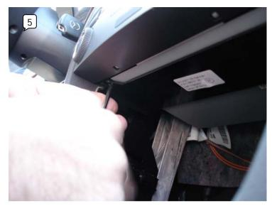
➤ Allentare quindi le brugole di fissaggio poste sotto il blocco radio, visibili in figura 5, ed estrarre infine la radio. Liberarla dalle sue connessioni elettriche
